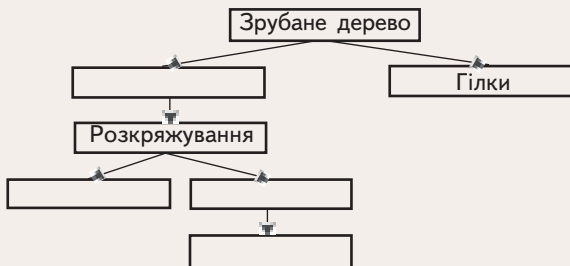
Рис. 2.6. Схема виготовлення круглих лісоматеріалів
