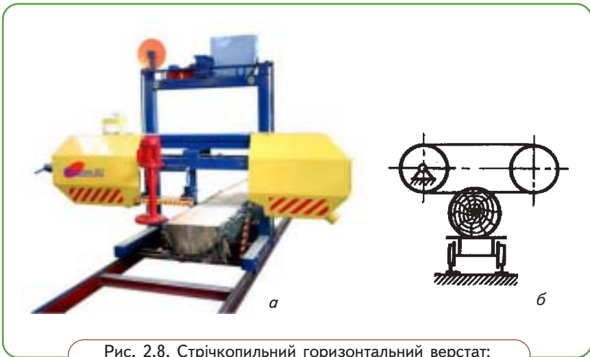
Рис. 2.8. Стрічкопильний горизонтальний верстат: а — загальний вигляд; б — схема пиляння
