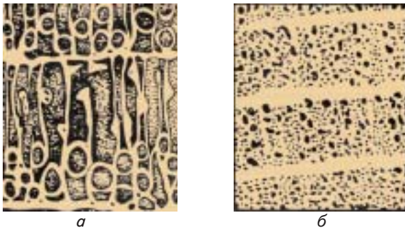
Рис. 2.4. Будова річного шару кільцесудинних (а) і розсіяносудинних (б) порід
