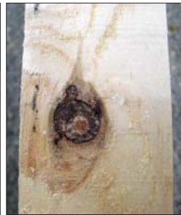
Рис. 5. Сучки снижают визуальное качество и прочность лесоматериала
