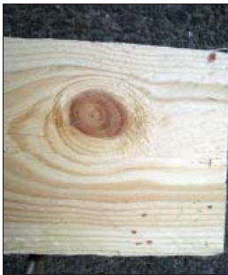
Рис. 5. Сучки снижают визуальное качество и прочность лесоматериала
