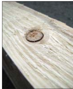
Рис. 5. Сучки снижают визуальное качество и прочность лесоматериала
